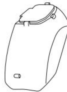
Reservatório de areia
